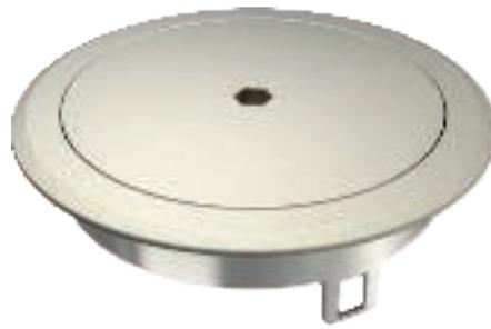
Blinddeckel mit Innensechskant für Bodensteckdose GES R2 zum direkten Einbau in die Installationsdose MT R2. Die Deckelausführung kann als Kabelauslass genutzt werden. Im geschlossenen Zustand erfüllt die Bodensteckdose die Anforderung der EN 50085-2-2 an nass gepflegte Böden.
